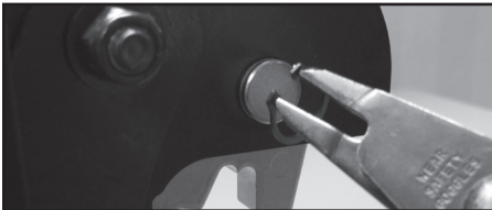
Retire los anillos de fijación de los pasadores de dado superior e inferior.
