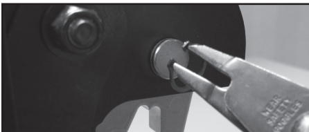
Enlever les bagues à ressorts des broches des bagues inférieures et supérieures.
