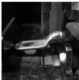
5. Ajuster la plaque de guidage afin que le connecteur soit placé dans la matrice prêt pour le 1er sertissage.
