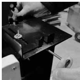
4. Retenir la bague inférieure et tirer la poignée de déverrouillage.
