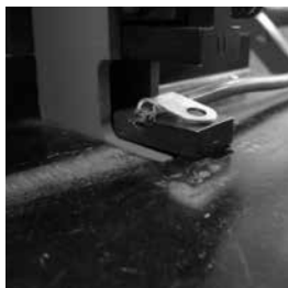
Installation correcte du connecteur à joint brasé dans la matrice inférieure.
