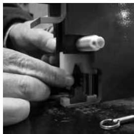
10. Insérer l'axe de la matrice supérieure.
