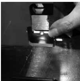
2. Installer une matrice en position inférieure.
