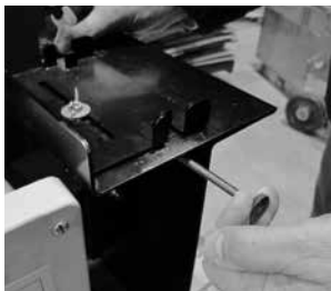
Retenedor de troquel inferior activado por resorte.
