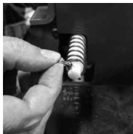
6. Enlever la tige de retenue et le ressort à partir de la tige de la bague supérieure.
