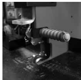
4. Installation des matrices terminée.
