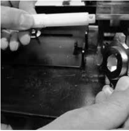
7. Remove upper die pin and die.
