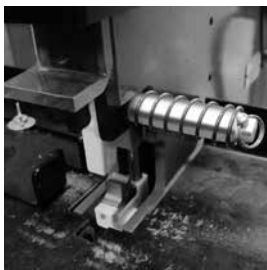
11. Insérer la broche de la bague supérieure.
